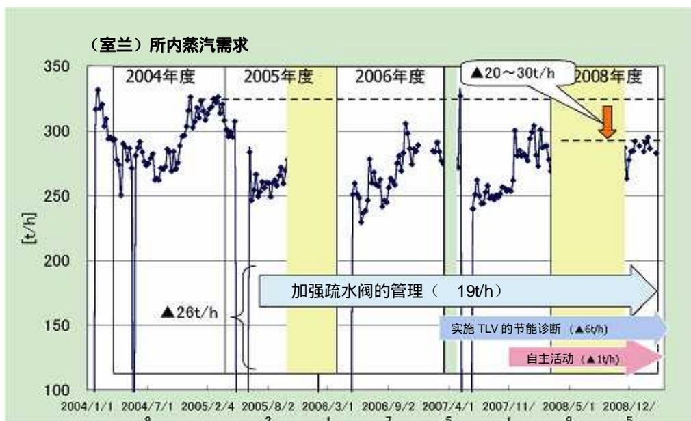
图-7 锅炉蒸发量的推移
