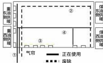
图 23 机械厂房的蒸汽管道（仅、）
