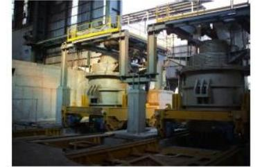
Four à arc électrique Thermomelt
